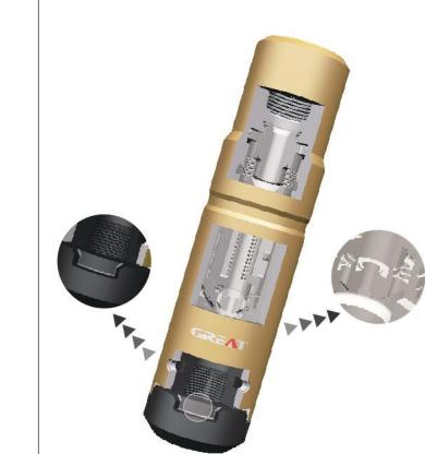
扭力冲击器将钻井液动能通过转换将扭矩直接作用在钻头上减少钻头的 粘滑运动,可更好的改善机械钻速并可以保护钻头,延长钻头寿命。 减少钻柱组件的疲劳
